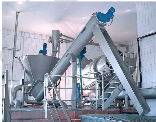
Slika 67. Uređaj za pranje peska
