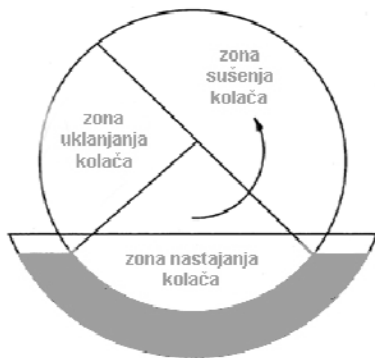
Slika 157. Vakuum-filter za obezvodnjavanje mulja
