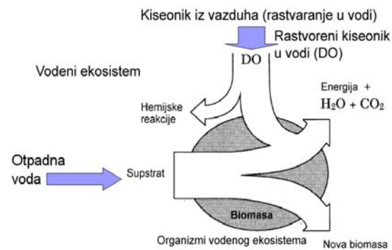
Slika 9. Mehanizam potrošnje kiseonika u vodenom ekosistemu
