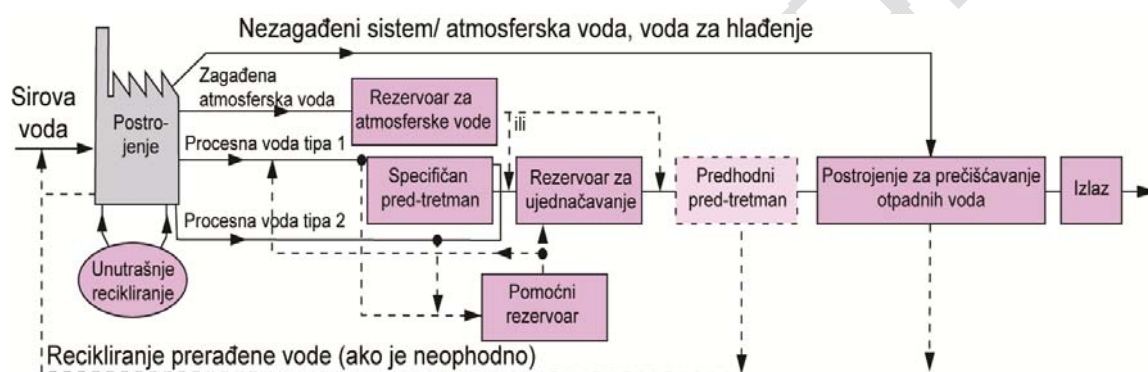
Slika 167. Prikaz opšteg sistema prečišćavanja industrijskih otpadnih voda
