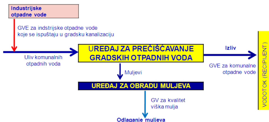
Slika 172. Šematski prikaz kanalizacionog slivnog područja grada sa postrojenjima za prečišćavanje otpadnih voda
