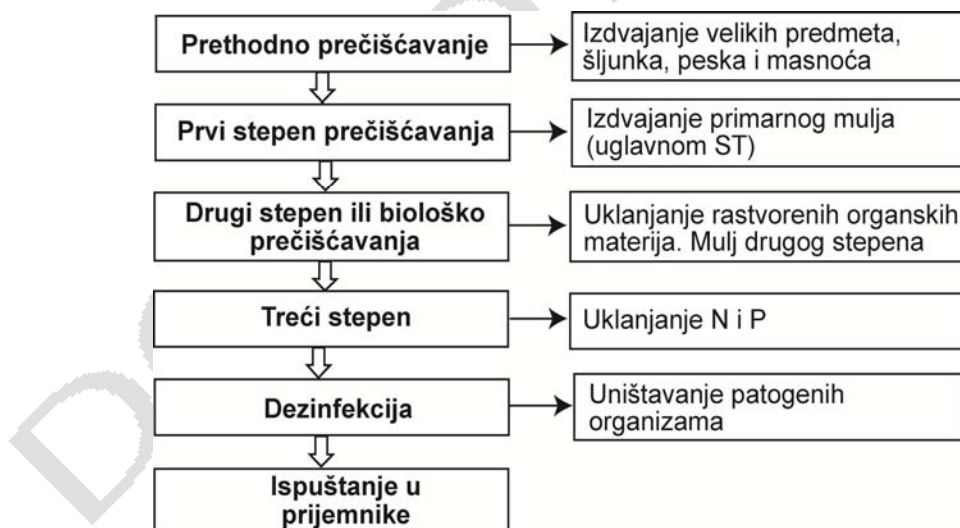
Slika 165. Opšta šema prečišćavanja komunalnih otpadnih voda
