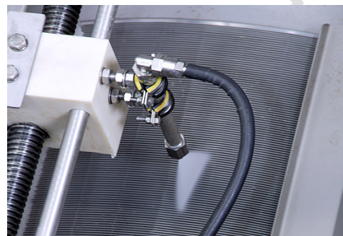
Slika 56. Mlaznica za ispiranje bubnja rešetke
