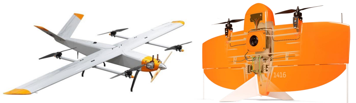
Slika 29. Hibrid koptera i drona sa fiksnim krilima (Baskaran K)
