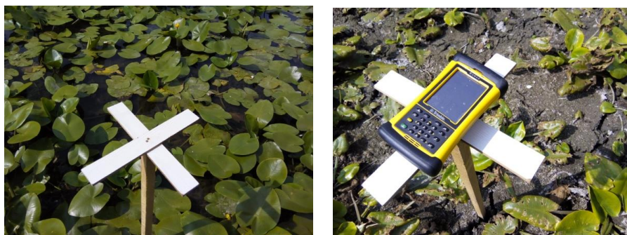
Slika 80. Postavljanje referentnih tačaka i njihovo georeferenciranje pomoću GNSS uređaja
