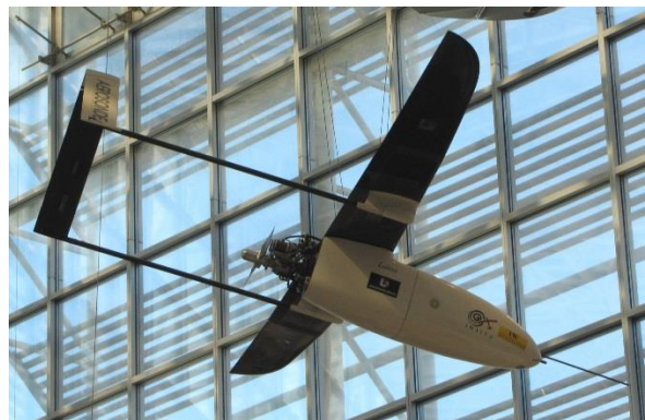
Slika 23. AAI Aerosonde – Laima duga 1.7m
