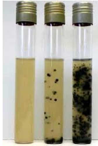
Slika 9. Sulfitoredukujuće klostridije u dubokom agaru, u kome u anaerobnim uskovima stvaraju crne kolonije od produkovanog H 2 S, koji reaguje sa gvožđem u podlozi i nastaje crni FeS https://www.scharlabmagyarorszag.hu/katalogus/01-634_TDS_EN.pdf
