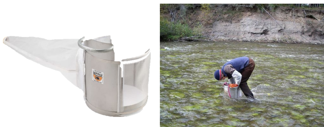
Slika 87. Hess-ov uzorkivač; model (levo), primena (desno).
