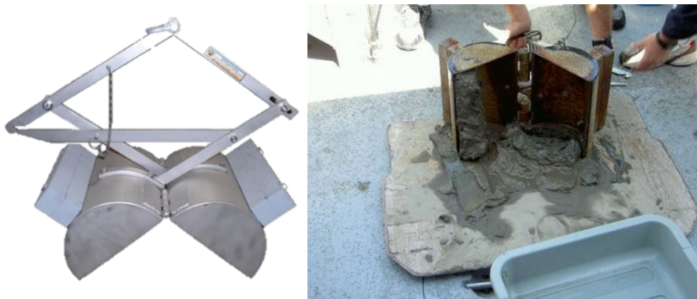
Slika 88. Petersonov bager; model (levo), primena (desno).
