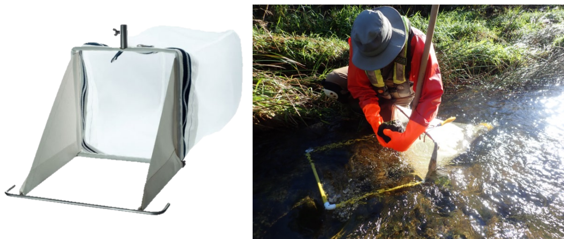
Slika 86. Surberova mreža; model (levo), primena (desno).
